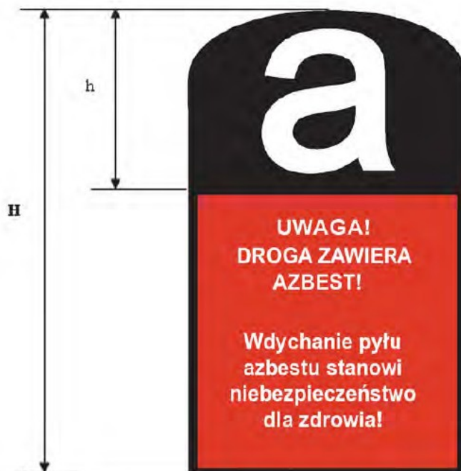
Rysunek 3. Wzór oznakowania dróg utwardzonych odpadami zawierającymi azbest przed wejściem w życie Ustawy z dnia 19 czerwca 1997 r. o zakazie stosowania wyrobów zawierających azbest, ale niezabezpieczonych trwale przed emisją włókien azbestu
